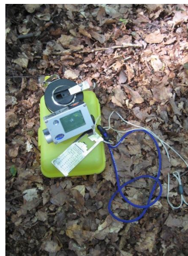
Abb. 5: Umfangsmaßband, Ultraschallentfernungsmesser (Vertex) und Dendrometer – Geräte für die Bestandserfassung (Bielefeldt 2010)
